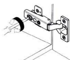
3. Регулировка по глубине
